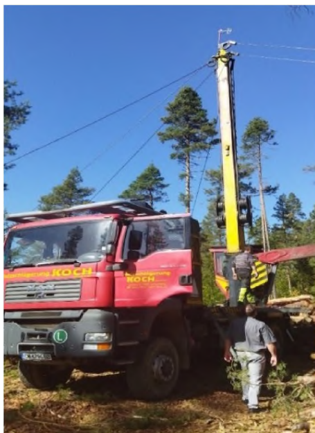
Фиг. 3. Преносима късометражна въжена линия Konrad Forsttechnik
